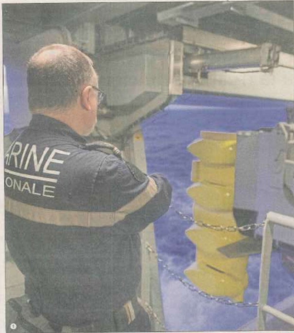
1 Mise à l'eau du sonar remorqué à bord de la frégate multimissions Provence.
