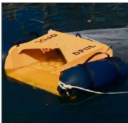
Muni d'un pompe qui aspire efficacement les déchets de surface et les stocke dans un sac, le "DPOL" a fait l'objet de tests grandeur nature dans le port de Toulon. L'engin est désormais opérationnel et sa commercialisation débutera en septembre. (Photos DR)
