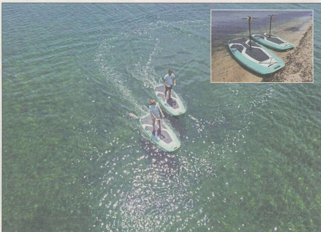
Ressemblant à une planche de paddle à laquelle on aurait rajouté un guidon et un moteur, le BlueWay pèse environ 50 kg et peut supporter jusqu'à 150 kg, permettant ainsi de monter dessus à plusieurs. (Photos DR)
